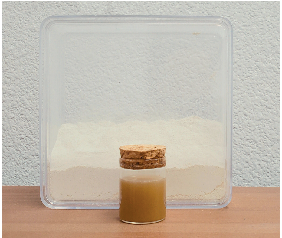
Wat overblijft na resomeren: effluent (restvloeistof) en as (na verpulvering)
