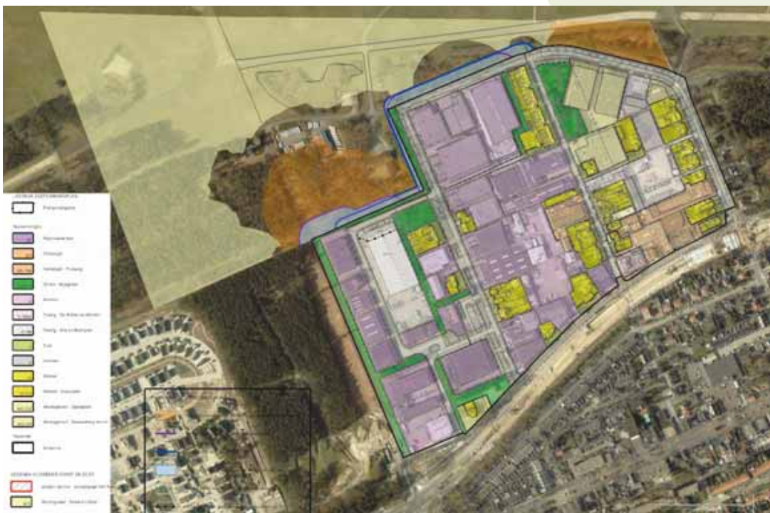
Het gebied Soesterberg-Noord, met daarop: het bedrijventerrein (paars); het 'wonen bij recht'-gebied (lichtgeel); en het woongebied met een geluidsuitstraling vanuit bedrijven die nog tijdelijk wordt geaccepteerd (oranjebruin). Uiteindelijk moet die geluidsuitstraling zijn teruggedrongen tot aan de paarse lijn langs het bedrijventerrein.
